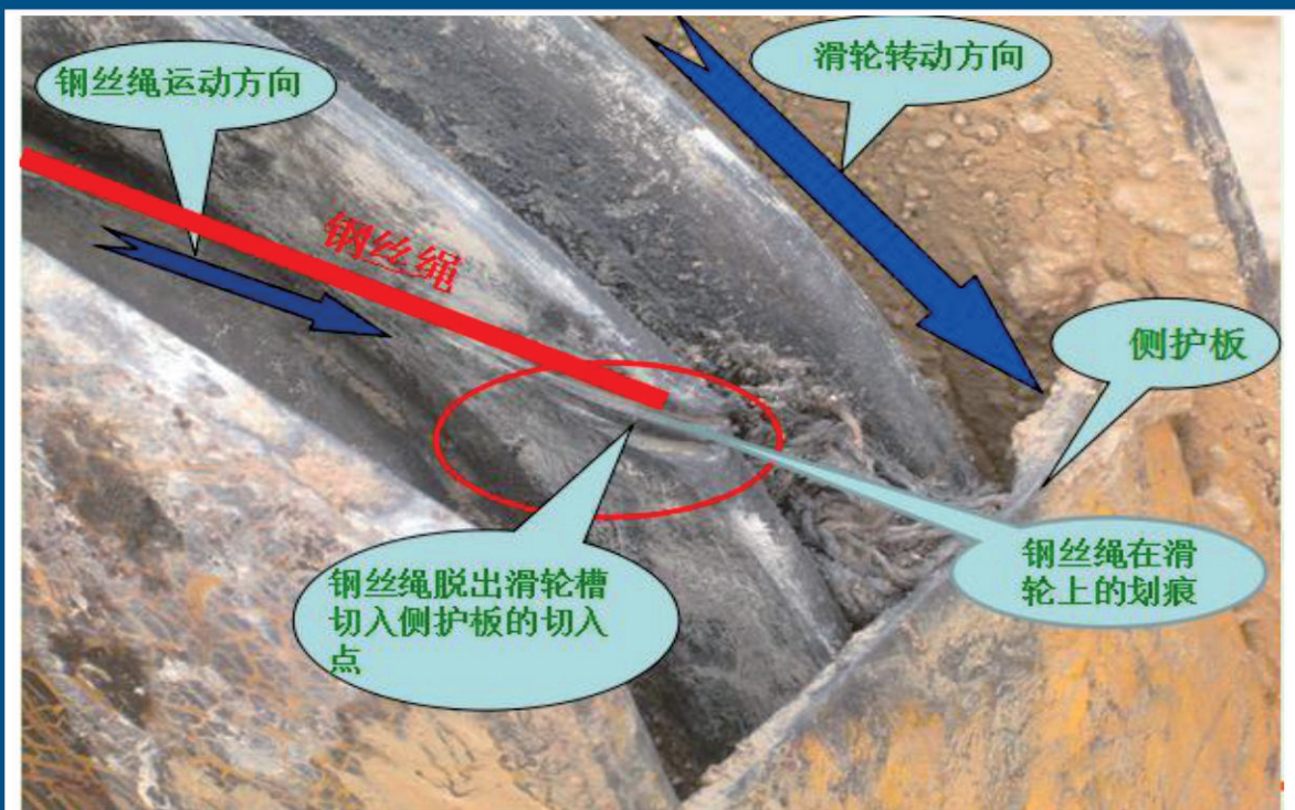
钢丝绳脱出滑轮槽切入侧护板示意图
